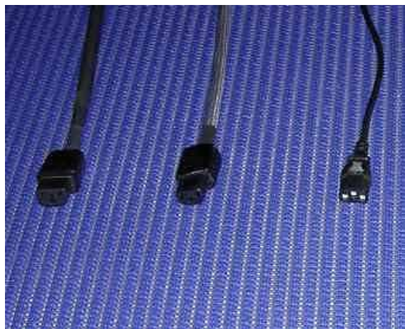
Da sinistra un esemplare di fabbrica, il BlackWire e il Cavo PC. I primi due hanno diametro esterno quasi uguale ma conduttori Interni ben diversi (3x1,5 contro 3x2,5)
