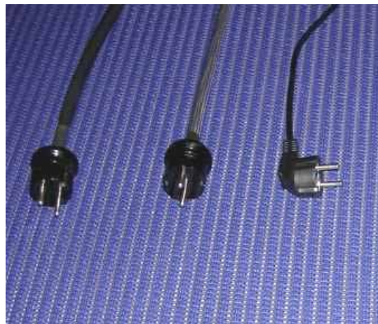
In formazione come a fianco. Gli esemplari di cavo PC che ho usato hanno tutti spine Schuko, ma molti in giro montano addirittura italiane "piccole" (10A)
