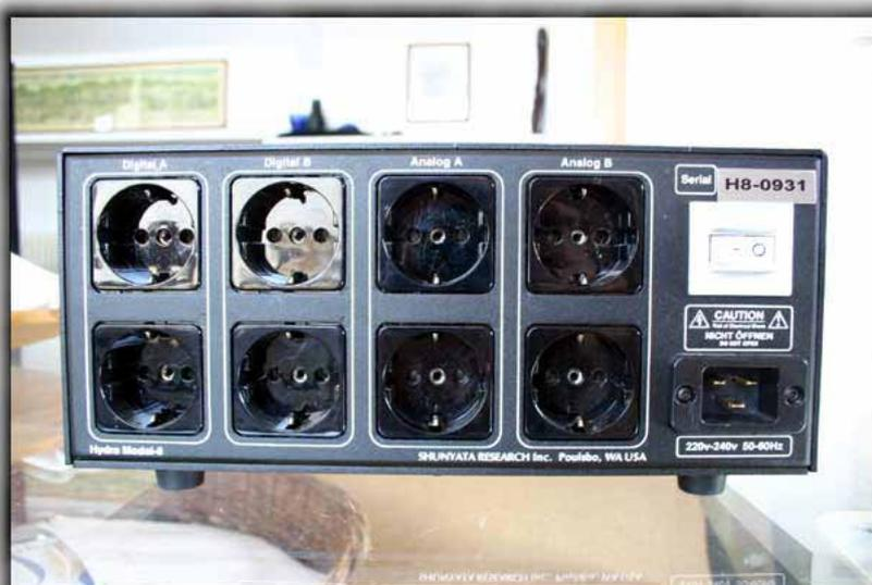
L'HYDRA 8 è un'unità passiva che si presenta come un parallelepipedo di ottima fattura e finitura, il frontale è in alluminio sul retro troviamo un ingresso a norme IEC da 20 ampere e otto uscite di ottima qualità adatte solo alle spine Shucko. L'apparecchio è in grado di gestire fino a 2,5 Kw per cui
